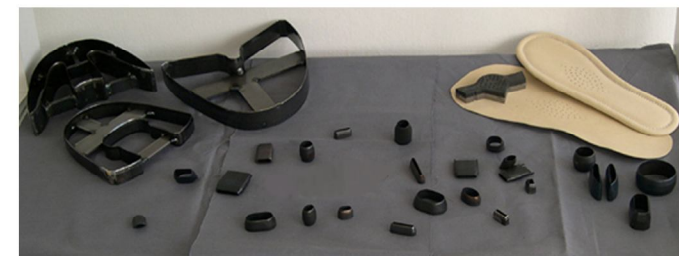
Cipőgyártáshoz használt kések, lyukasztók.
