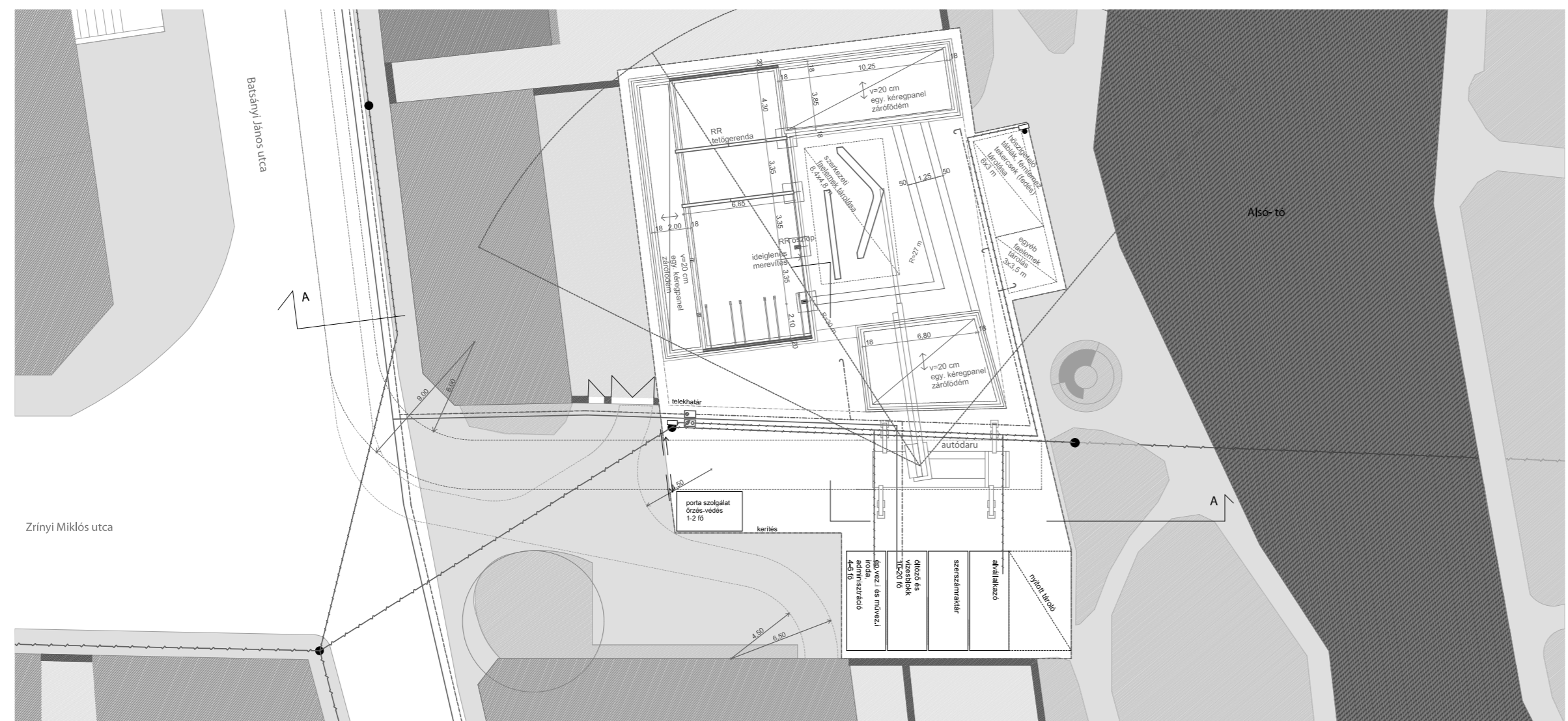
organizációs helyszínrajz, nagytérlem fa keretvázának szerelése M 1:300
