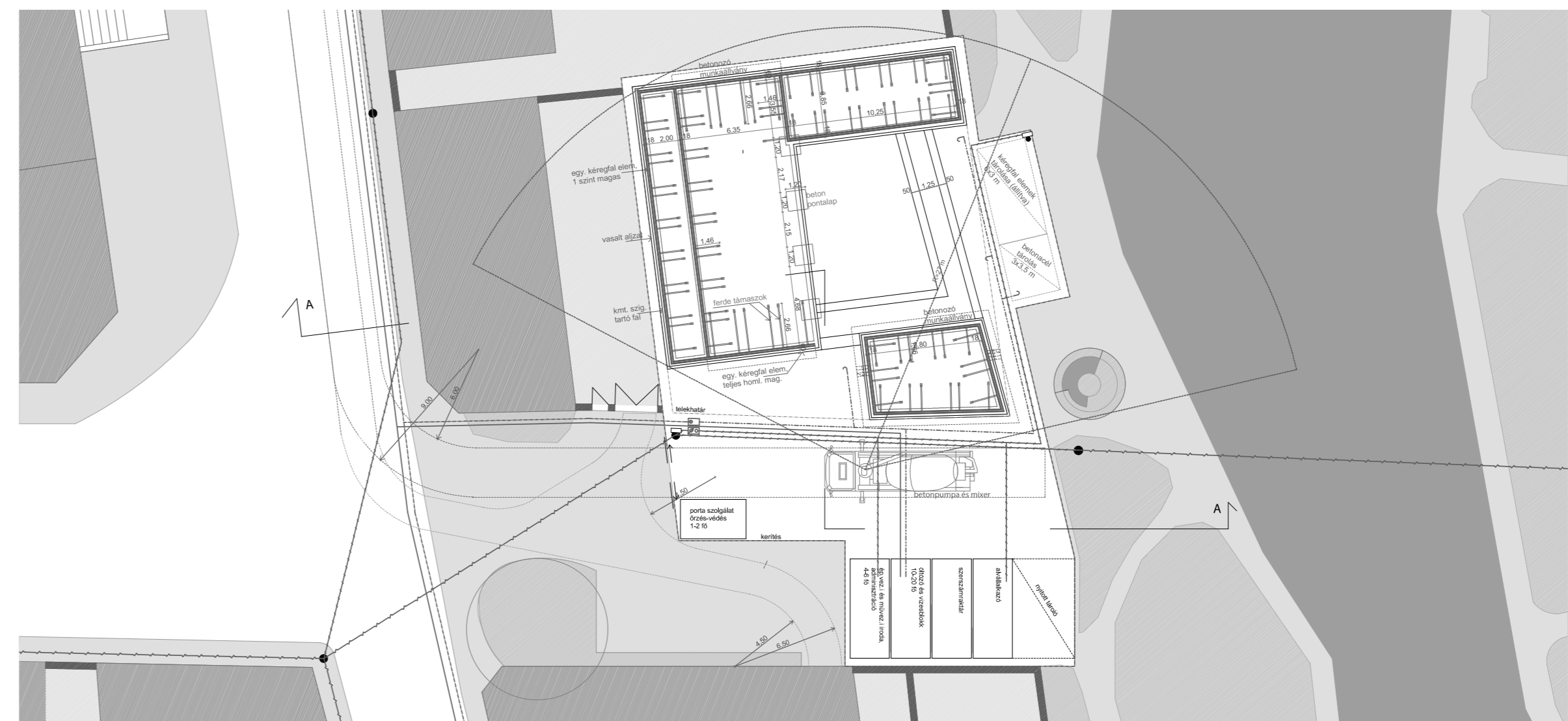
organizációs helyszínrajz, földszinti falszerkezet készítése M 1:300
