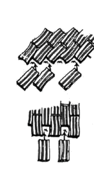
katalán boltozat téglacsempéknek illesztési módja 66. kép
