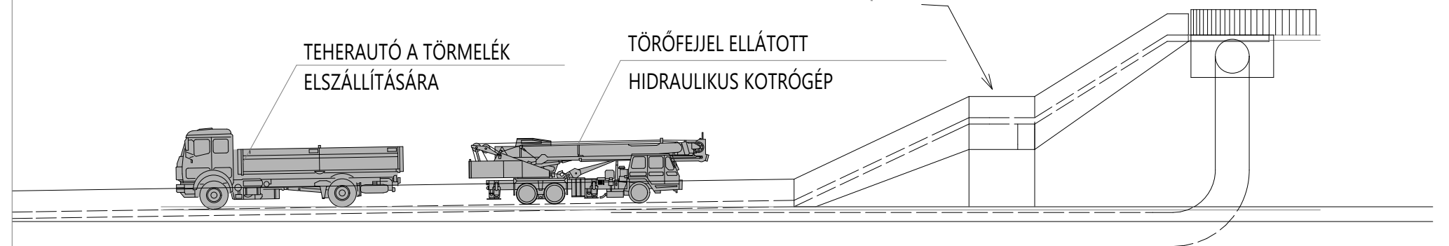
BONTÁSI MUNKÁK: MEGLÉVŐ LÉPCSŐSZERKEZET BONTÁSA HOSSZMETSZET 1:250
