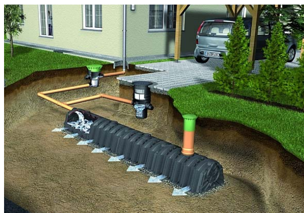
Szikkasztórendszer (kép: Kontakt-R Kft.)
